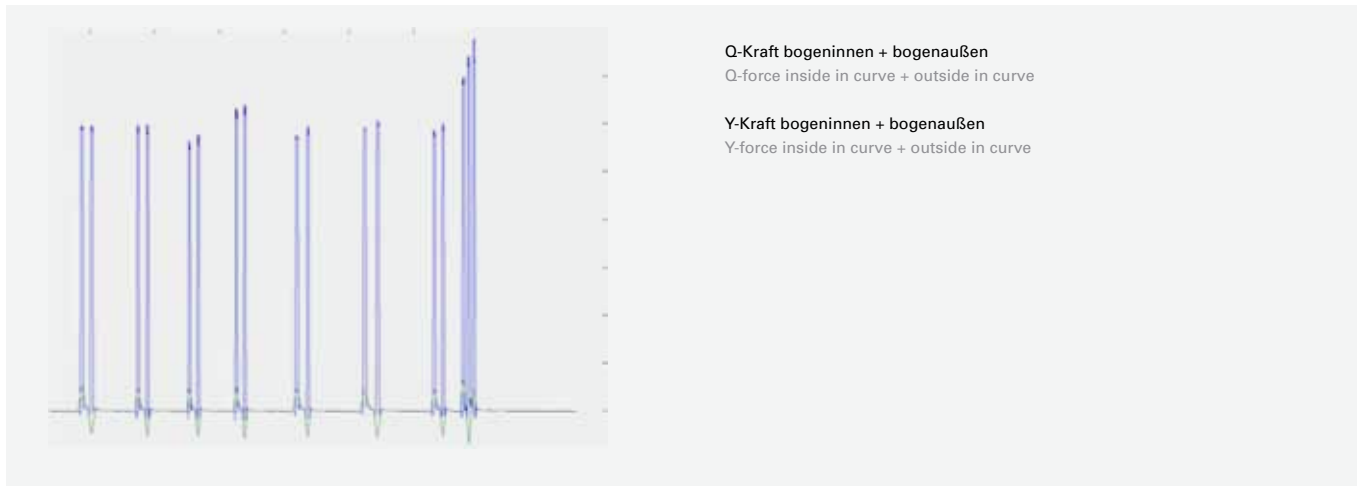
Bild 23: Y/Q-Signal eines „vorlaufenden“ Radsatzes
