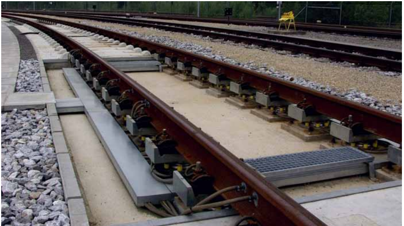
Bild 20: Messverfahren für Q-Messung
