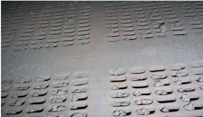
Bild 1: Einsatz einer Spannwellensiebmaschine vermindert u.a. Steckkorn
